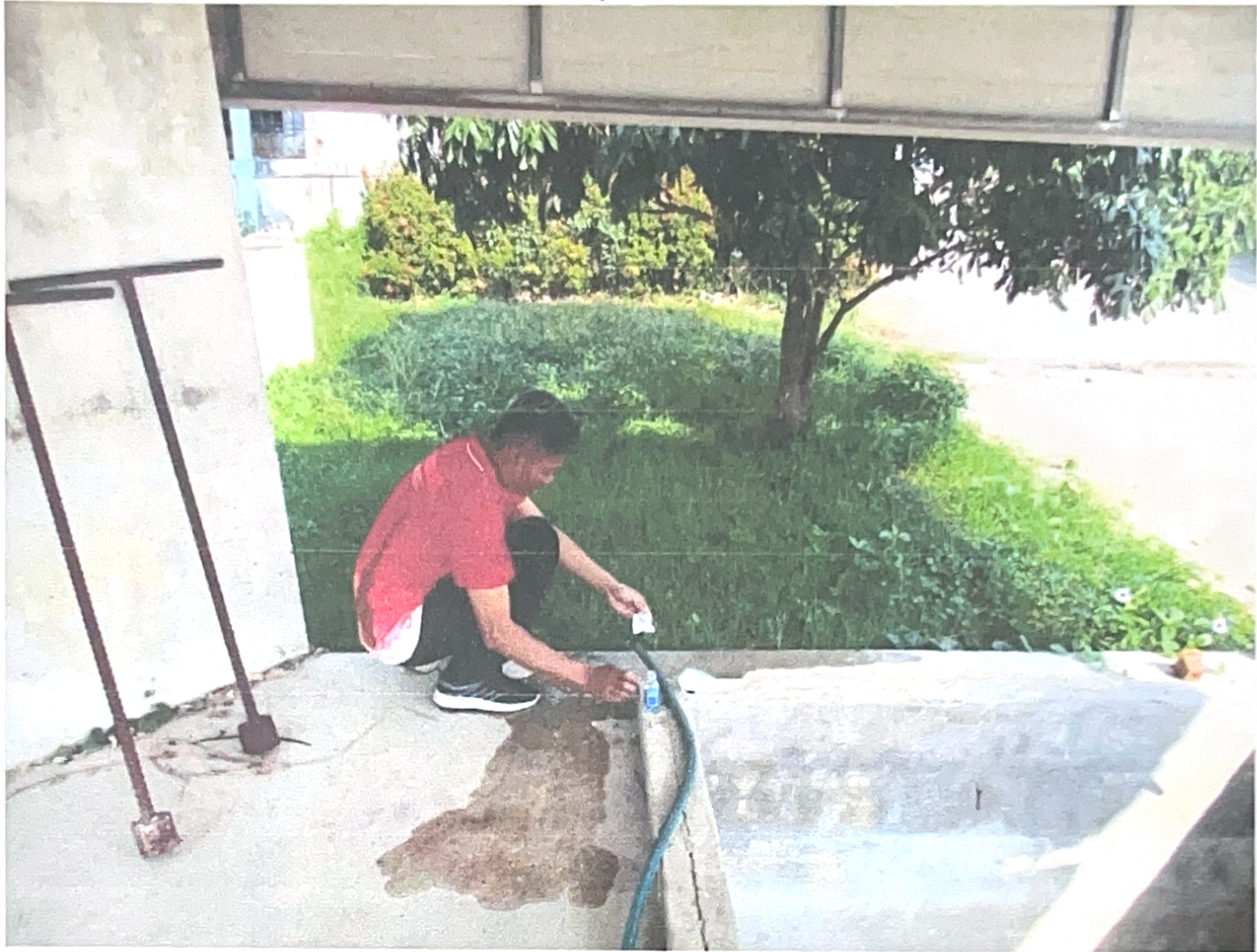
รูปภาพ การเก็บตัวอย่างน้ำประปา ณ บริเวณจุดผลิตน้ำประปาของ เทศบาลตำบลเขียงยืน หมู่ที่ ๑๘ เพื่อนำส่งตรวจที่สำนักงานสาธารณสุขมหาสารคาม วันที่ ๒๒ เมษายน ๒๕๖๘
